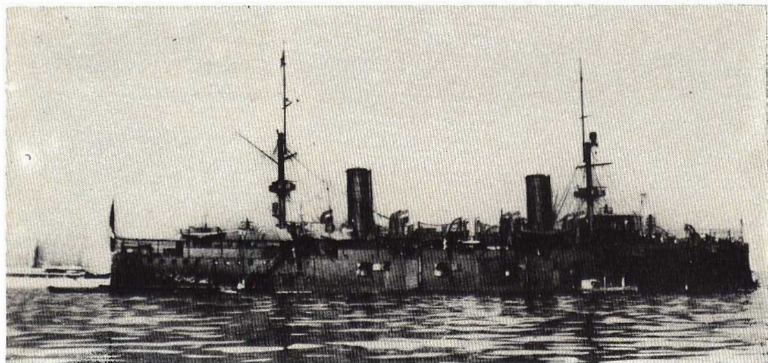
Fig. 1 - La corazzata Carlo Alberto sulla quale Marconi esegui i celebri esperimenti. La foto ritrae la nave priva dell'aereo a ventaglio già sostituito con quello orizzontale.
