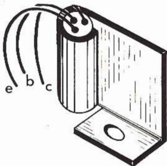
Fig. 5 - Come si devono piegare i terminali del transistor TR3 per il fissaggio sul dissipatore.
